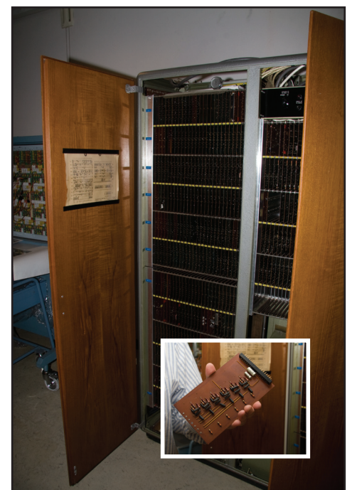
Trondheims første digitale datamaskin: Denne maskinen består av et utall kort med såkalte "ikke-integrerte kretser". All lodding ble utført av damer, fordi menn ikke var nøye nok.
