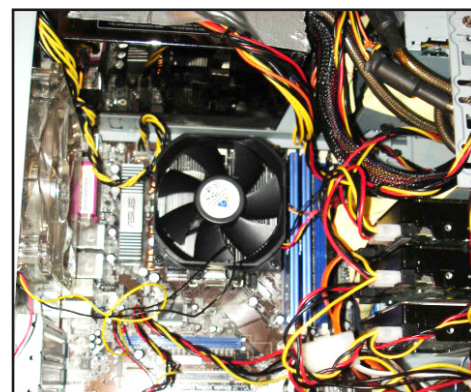
Dårlig airflow = Høye temperaturer
